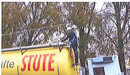
Fot. 1. Biegły wszedł po fabrycznie zamontowanej drabinie i rozłożył barierkę ochronną
