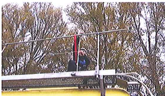
Fot. 2. Dokonano kontroli zabezpieczenia cysterny barierką ochronną – poręcz górna na wysokości 98 cm.
