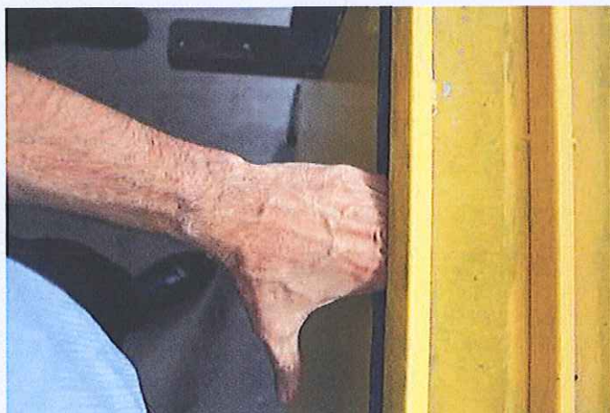
Fot. 2. Przy prawidłowo zamontowanej osłonie, tj. bez odkręcenia śrub i podłożenia pod osłonę zużytych rolek po taśmie, biegły zdołał włożyć swoją dłoń na 95 mm
