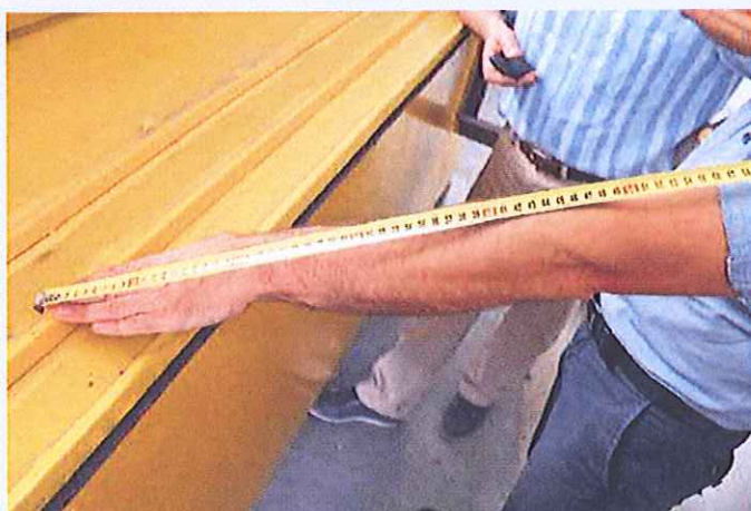
Fot. 6. Dokonano pomiaru włożonej ręki. Uzyskano wymiar 430 mm
