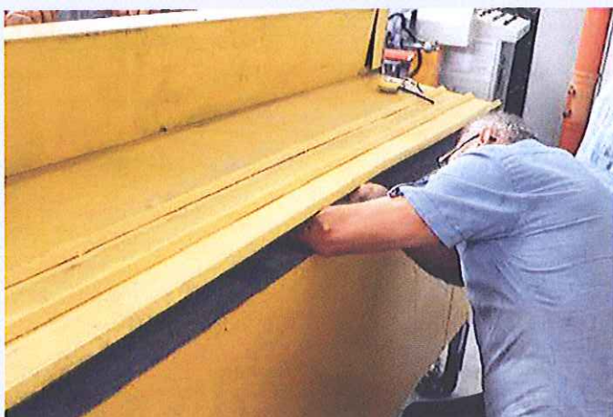
Fot. 5. Biegły włożył swoją lewą rękę pod osłonę po łokieć. Dalej nie mógł jej włożyć ze względu na ograniczenie osłony, tj. górnej krawędzi
