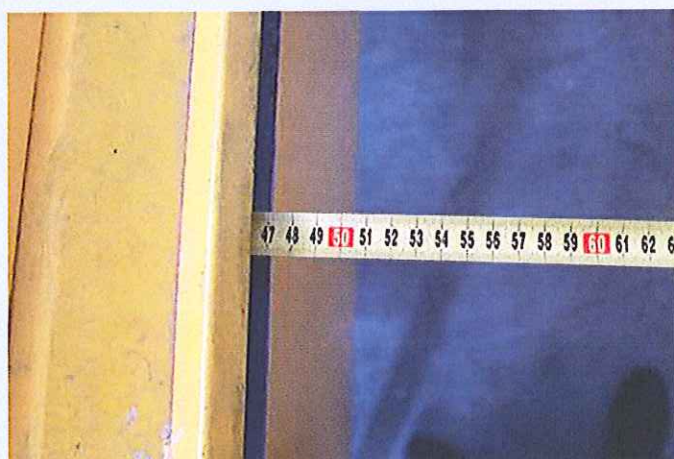
Fot. 3. Pila przecinarki do pianki oddalona od krawędzi osłony o 470 mm
