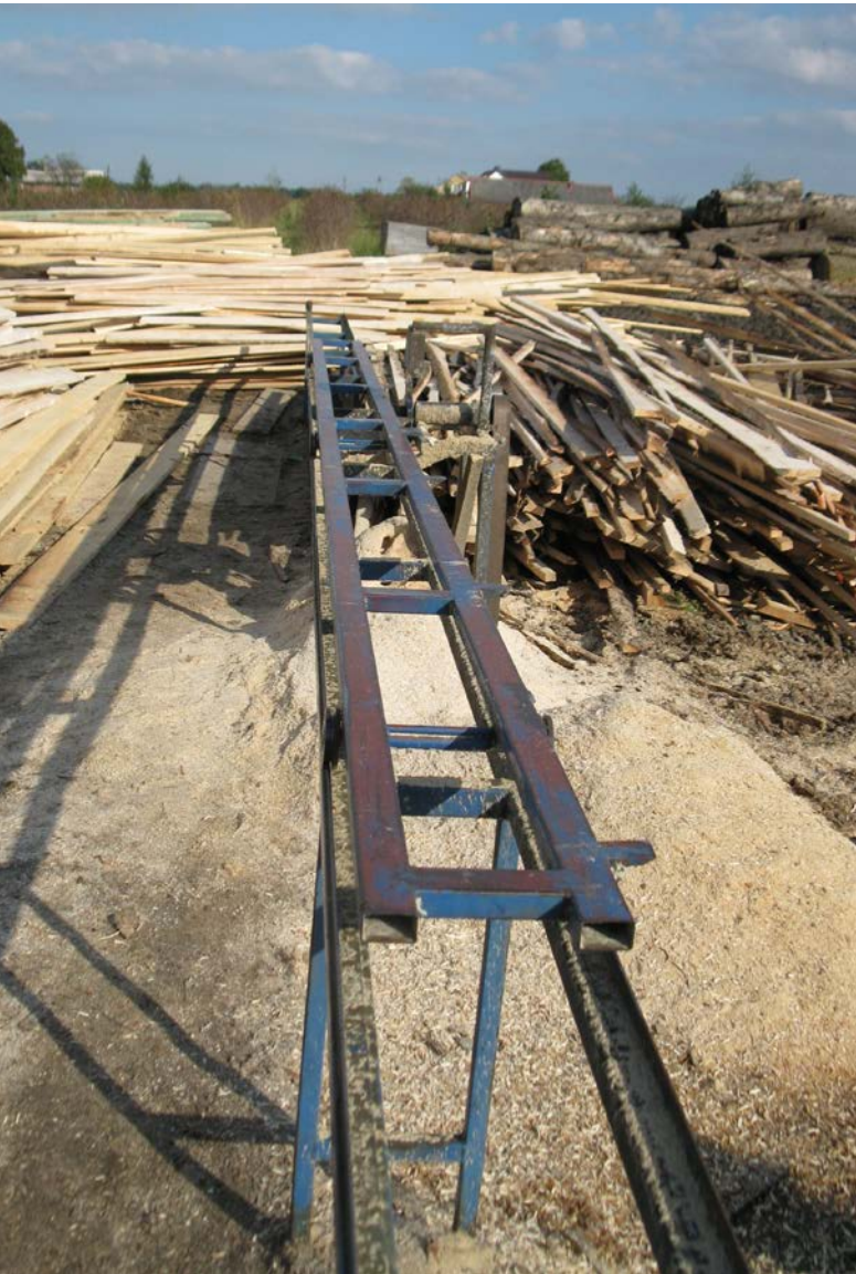
Fot. 3. Wózek z posuwem wzdłużnym
